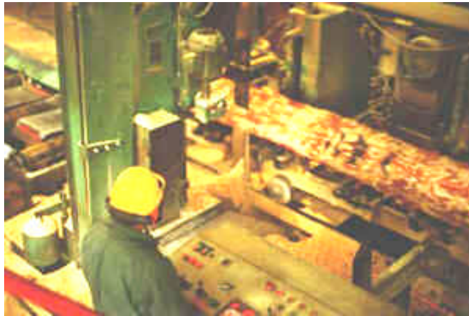
Proceso de Aserrado de Madera, donde se generan residuos finos a la atmósfera del lugar y residuos de mayor envergadura (aserrín, virutas, despuntes, tapas, etc.)
