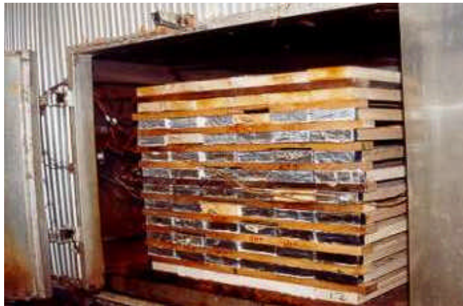
Madera finalizando el proceso de secado en horno.
